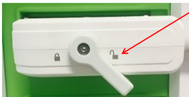
Figura 9. Palanca de bloqueo del conector del transductor desbloqueada
